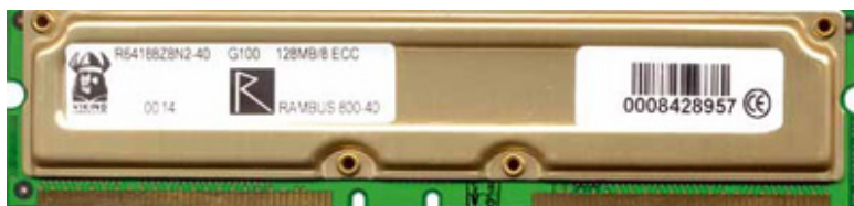
وحدة (لوح) ذاكرة من الشكل (RD-RAM) RIMM
